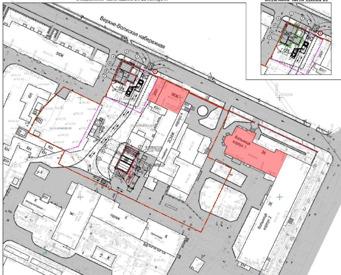
Схема организации работ по сносу (демонтажу) подземной части здания 21/22 Литера К
